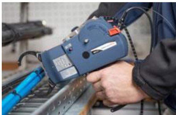
L'aménagement du plan de travail, soit en banc fixe (avec un positionnement vertical ou horizontal de l'outil) ou en suspension haute sur potence, permet à l'ATS Flex d'être utilisé aussi bien en poste fixe qu'en poste mobile. Un dispositif spécial d'assemblage automatique permet d'intégrer complètement l'outil dans des lignes de production automatisée.
