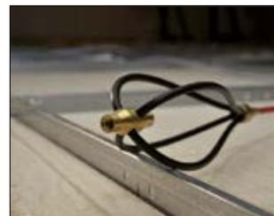
Le fouet permet de guider les câbles sur des surfaces rugueuses ou inégales et de passer des obstacles.
