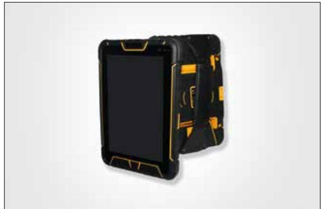
Tablette industrielle RFID-HT17-HF/UHF pour lire et écrire sur des puces RFID.
