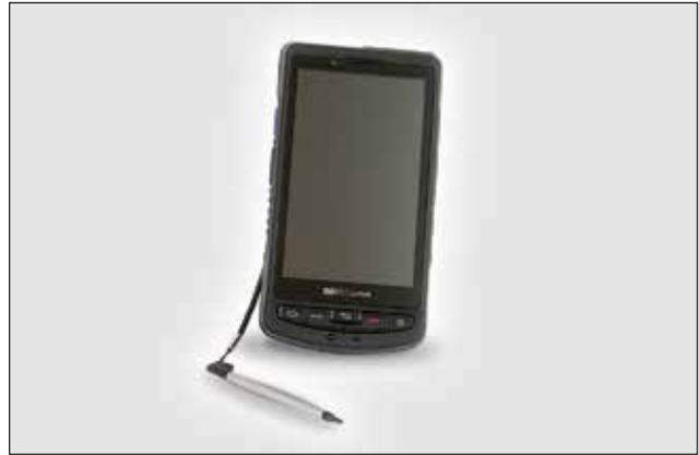
Lecteur/encodeur premium tactile RFID-RP1600T-HF-GSM haute fréquence 13.56 MHz.
