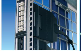
Zero U - la solution compacte pour les Data Centres - est une armoire RapidNet prête à l'emploi économisant jusqu'à 20% d'espace de chassis dans un Data Centre grâce à l'espace Zero U, en présentant une connectivité verticale et en offrant davantage d'espace aux équipements actifs.
