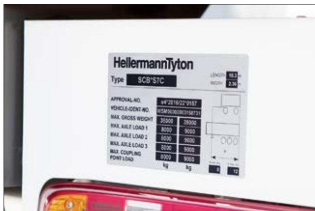
Plaque signalétique d'une remorque avec une étiquette de protection
