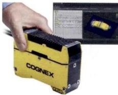
La caméra intelligente In-Sight 3D-L4000 comporte une technologie de déplacement laser 3D. Son optique brevetée à laser bleu limite les reflets. Les utilisateurs capturent et traitent rapidement des images 3D de haute qualité lors d'inspections, de guidages et de jaugeages en ligne. Pour plus de précision, les outils de vision peuvent être placés directement sur une image 3D de la pièce. L'interface intuitive de la feuille de calcul In-Sight permet de configurer
