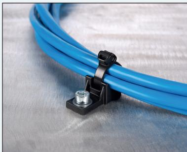
*Les lanières de la série HDM offrent un maintien sûr et puissant des câbles, tubes et faisceaux. Elles sont particulièrement adaptées au maintien de tubes et gaines annelées grâce à leur ergot de centrage qui vient s'intercaler dans une rainure.*
