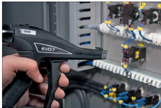
Pince EVO7 pour colliers en plastique de largeur max 4,8 mm.
