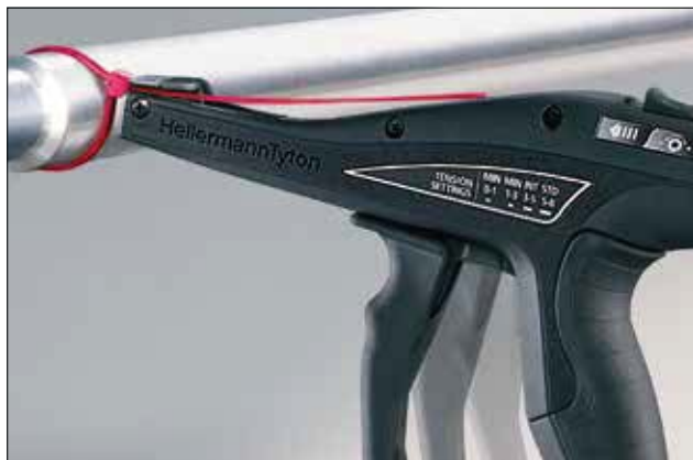
1: Serrage du collier, tel n'importe quel outil manuel de pose.
