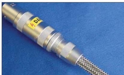
Les gaines **Helagaine EMC** sont fabriquées à partir de cuivre étamé et de fibres de polyester; elles sont adaptées à la protection des câbles contre les rayonnements, même dans des applications utilisant des composants sensibles. Une fois expansée, cette gaine tressée innovante retrouve son diamètre d'origine.
