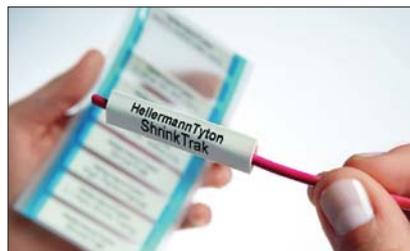
**ShrinkTrak** est un manchon thermorétractable flexible et identifiable dont le taux de rétreint est de 3:1. Conçu pour fournir une impression nette, le support pratique qui se retire facilement permet de réaliser des marquages personnalisés.
