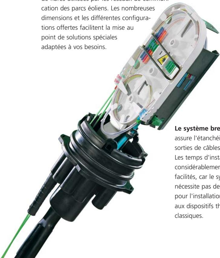
**Le système breveté Cablelok** assure l'étanchéité des entrées et sorties de câbles du coffret. Les temps d'installation sont considérablement réduits et facilités, car le système ne nécessite pas de source d'énergie pour l'installation, contrairement aux dispositifs thermorétractables classiques.
