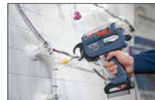
Fixation de colliers de serrage en bobine avec l'autotool CPK sur batterie, maintenu via une potence.
