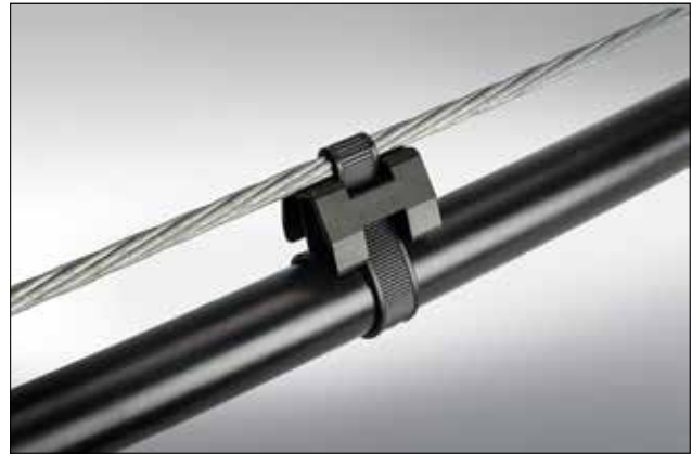
Les entretoises permettent de manager des câbles de façon parallèle et éviter qu'ils ne se touchent.
